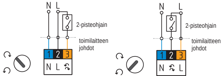
Kuva 10. Sähkökaavio 2-pistetoimilaitteesta, kytkentätoiminnon asetukset
